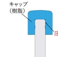
● FPDのキャップは、エラストマーキャップ(Rタイプ)を除きロッド先端に固定されています。
